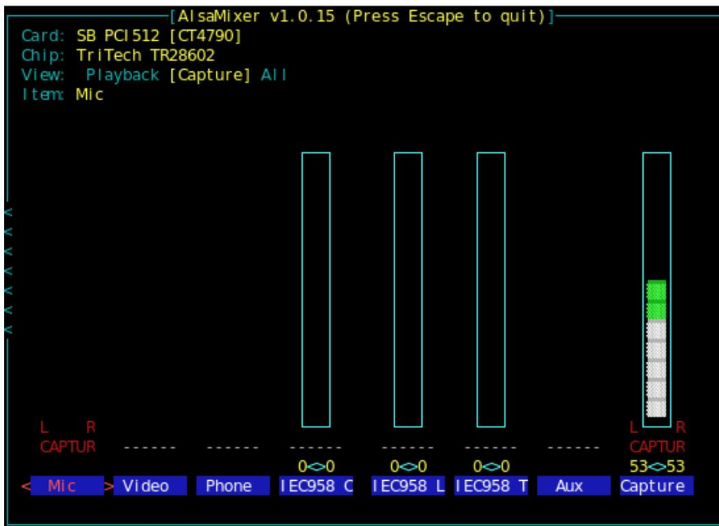
on utilise les flèches de direction pour choisir le canal « mix » et on appuie sur la touche espace. on ferme alsamixer, et maintenant il est possible de capturer le son.
